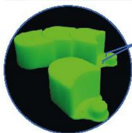
Predpripravljenje odprtine za vijake za pritrpitev fluorescentnih ABS elementov v tla
